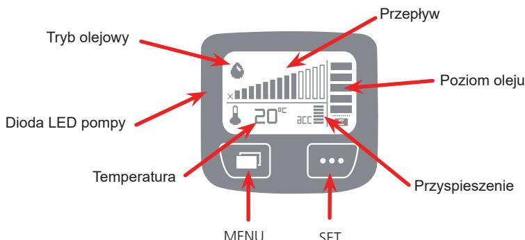
**Przepływ:** szybkość przepływu jest pokazana jako wykres słupkowy. Natężenie przepływu można ustawić od 1 kropli co 5 minut (najwolniejsze ustawienie) do 1 kropli co 20 sekund (najszybsze ustawienie). Naciśnięcie **SET** powoduje wyświetlenie przepływów.
