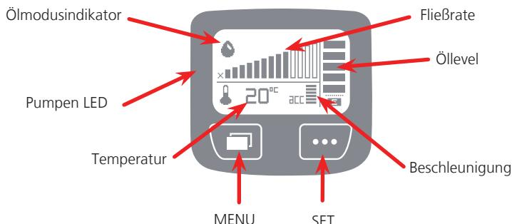
**Fließrate:** Die Durchflussmenge wird als Balkendiagramm dargestellt. Die Durchflussrate kann von 1 Tropfen alle 5 Minuten (langsamste Einstellung) bis zu 1 Tropfen alle 20 Sekunden (schnellste Einstellung) eingestellt werden. Durch Drücken von **SET** werden die Durchflussraten durchlaufen.
