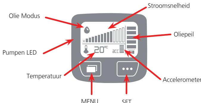
**Stroomsnelheid:** Het debiet wordt weergegeven als een staafdiagram. De stroom kan worden aangepast van 1 druppel om de 5 minuten (langzaamste instelling) tot 1 druppel om de 20 seconden (snelste instelling). Wanneer u op **SET** drukt, worden de stroomsnelheden doorlopen.
