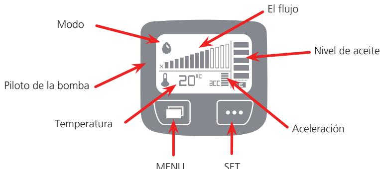
**Velocidad de flujo:** la velocidad de flujo se muestra como un gráfico de barras. El caudal se puede ajustar de 1 gota cada 5 minutos (ajuste más lento) a 1 gota cada 20 segundos (ajuste más rápido). Presione SET para recorrer las configuraciones.
